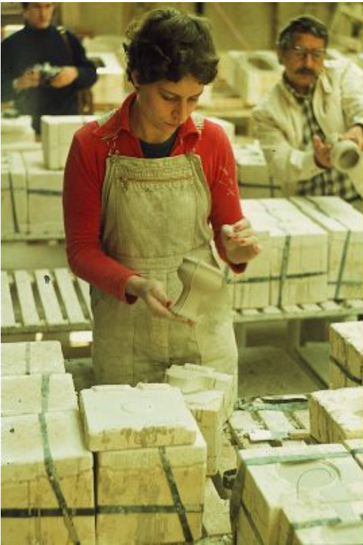
Figuur 1-14: De vloeibare klei wordt in een gipsen mal gegoten.
