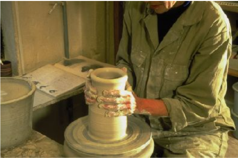
Figuur 1-11: De wanddikte van de vaas bepalen.
