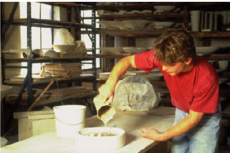
Figuur 1-14: De vloeibare klei wordt in een gipsen mal gegoten.
