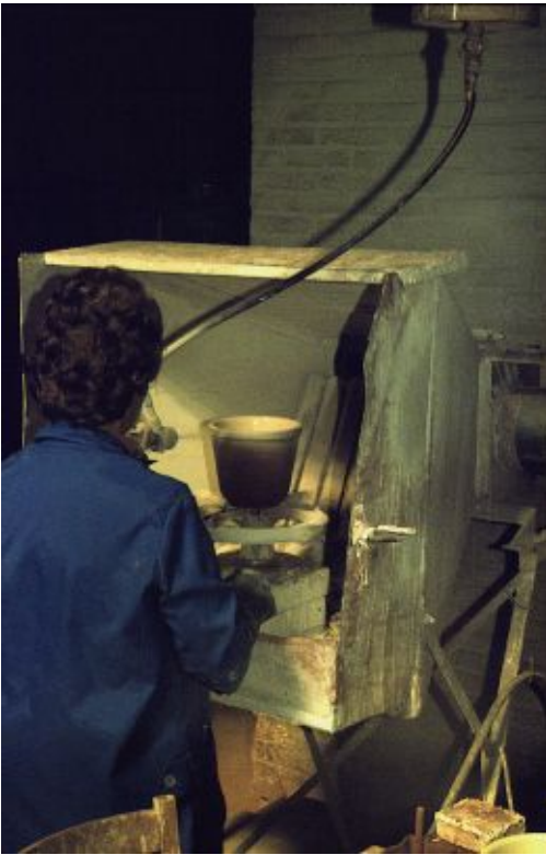
Figuur 1-19: Het voorwerp wordt in een spuitcabine geplaatst.
