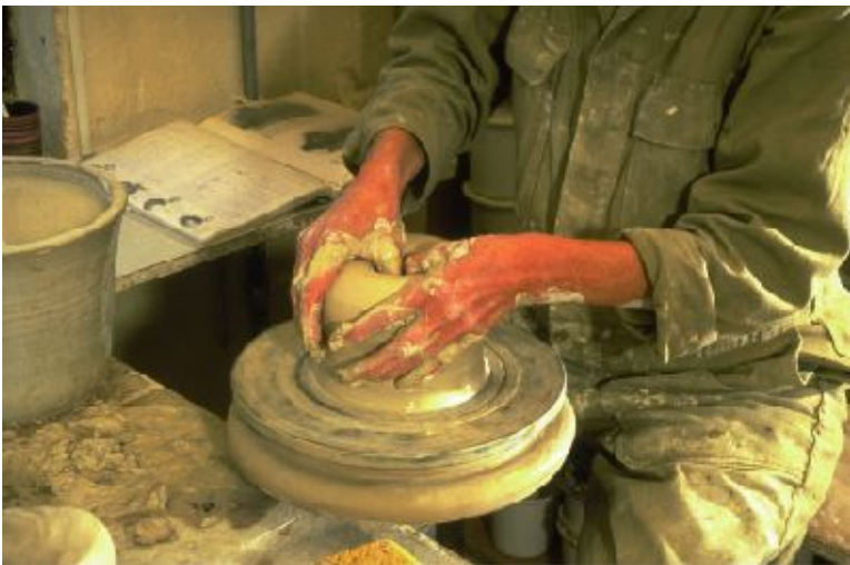
Figuur 1-9: De klei wordt met de duimen 'geopend'.
