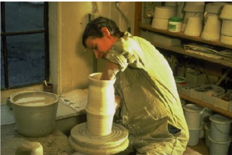
Figuur 1-11: De wanddikte van de vaas bepalen.
