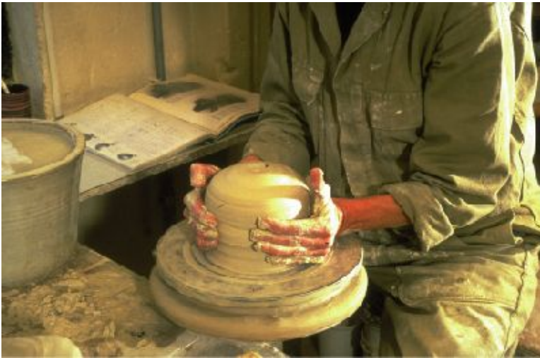
Figuur 1-9: De klei wordt met de duimen 'geopend'.
